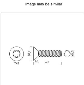
Actuator Size: Torx T8 DIN/ISO: DIN7500-M Drive Type: **TORX**
