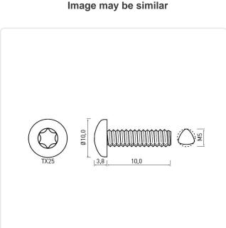
Actuator Size: Torx T25 DIN/ISO: DIN7500-C Drive Type: TORX
